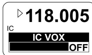
Lorsque VOX est éteint, l'activation du fonctionnement de l'interphone en utilisant l'interrupteur d'interphone externe (entrée discrète /IC) est toujours possible à tout moment. Le niveau du seuil VOX n'est pas réglable si la fonction VOX est forcée sur « OFF » (en raison d'un haut-parleur activé dans la configuration audio actuelle).
