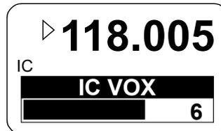
Le « CODEUR ROTATIF » permet de modifier le seuil VOX de l'interphone de -30 (le plus sensible, même un signal de microphone extrêmement faible déclenche déjà le seuil VOX pour le fonctionnement de l'interphone) à +10 (VOX est moins sensible et seul des signaux de microphone élevés déclenchent le seuil VOX pour le fonctionnement de l'interphone).
