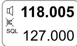
Lorsque le haut-parleur est actif en configuration audio, VOX est toujours forcé sur « OFF » et l'interphone via VOX est impossible (pour éviter une oscillation de la fonction VOX en raison d'un effet Larsen).
