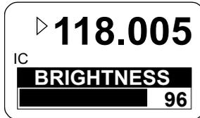
La luminosité du panneau pour l'éclairage de l'écran et des boutons-poussoirs peut être modifiée de 0 (éclairage éteint) à 100 (luminosité maximale) en tournant le « CODEUR ROTATIF ».
