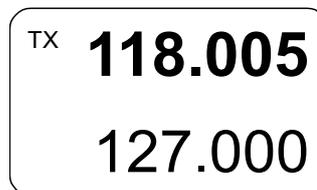
En mode émission, plusieurs actions de l'utilisateur, telles que la modification du mode de sélection de fréquence ou du mode d'espacement de canaux, qui sont normalement autorisées en mode réception, sont bloquées. (Exception : en mode standard, la fréquence « prédéfinie » peut toujours être modifiable, même durant la transmission).
