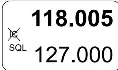
Modifier la fréquence active est impossible en mode standard (uniquement disponible en mode réglage direct), mais il est possible de modifier la fréquence prédéfinie.
