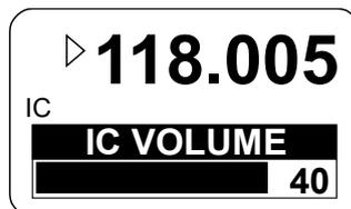
Le volume de l'interphone peut être modifié de zéro à 46 au moyen du « CODEUR ROTATIF ». Le paramètre de volume de l'interphone affecte le signal audio et de retours d'émission de l'interphone, acheminé vers le casque.
