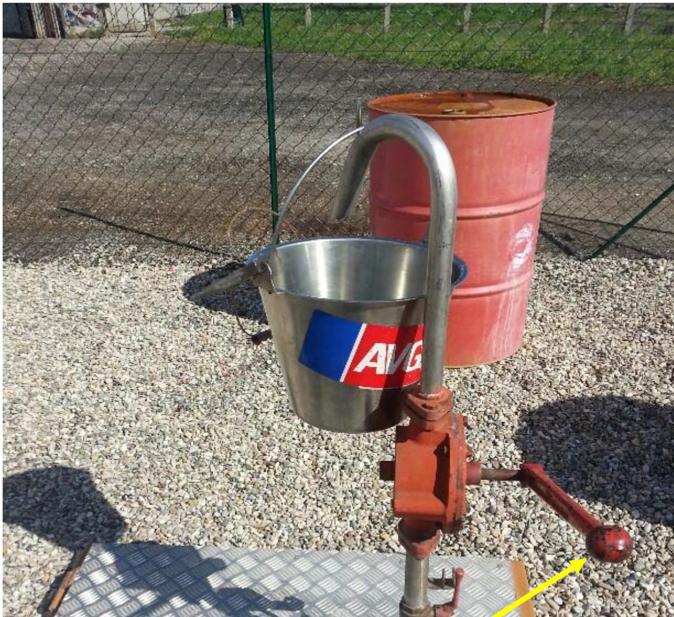
Pomper très énergiquement avec le levier d'une butée à l'autre pour amorcer la pompe
